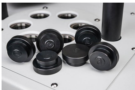
サンプル6個まで同時に埋め込み
