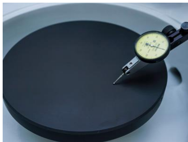
研磨面は高精度の平面なので綺麗に仕上がります。
