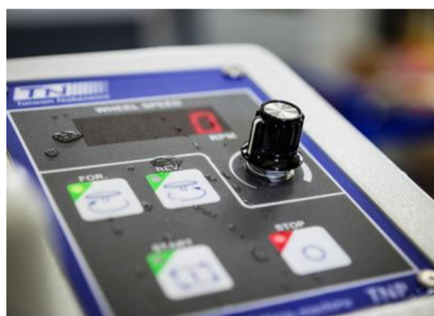
防水仕様のメンブレン操作部拡大写真
