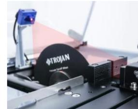
レーザー式切断位置調節機構
