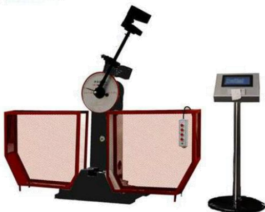
(写真上) パソコンなしデジタル表示のS300Bはケーブル接続の制御部で制御
