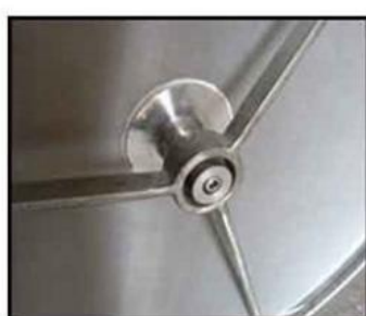
振動子取付部
