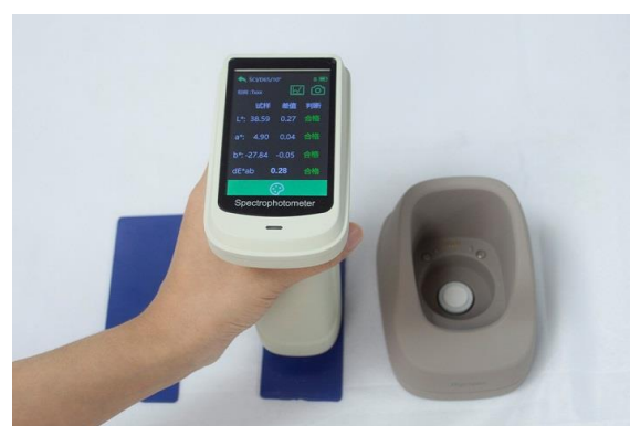
ハンドル下部にある開口部を試料にかざして測定します。
