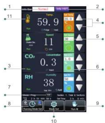
カラー静電容量式タッチスクリーン (インキュベーターシェーカー)
