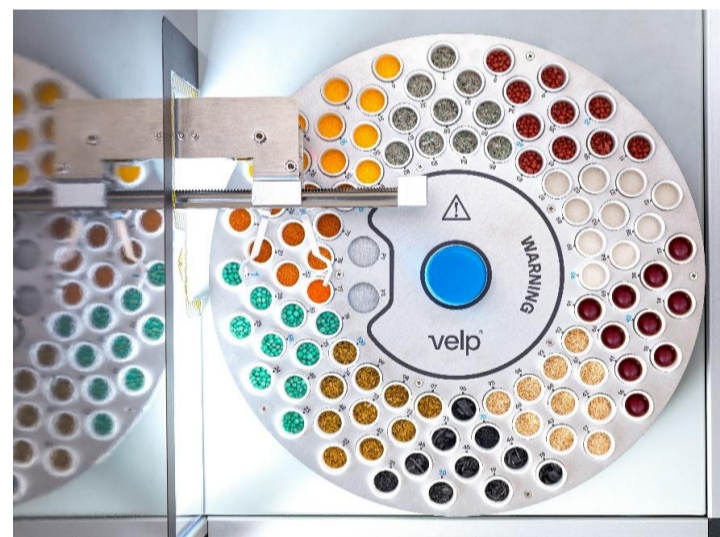
セラミック製のるつぼを採用し、サンプルディスク1枚あたり100ポジション
