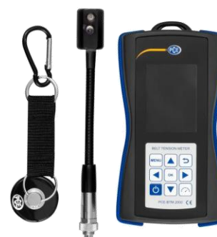
磁気ホルダー、センサーヘッド、本体
