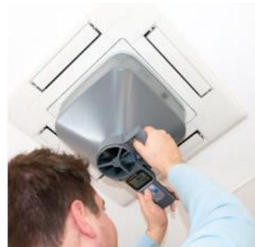
写真2：方形風量測定アタッチメントでのエアコン吸込み口の風量測定の様子
