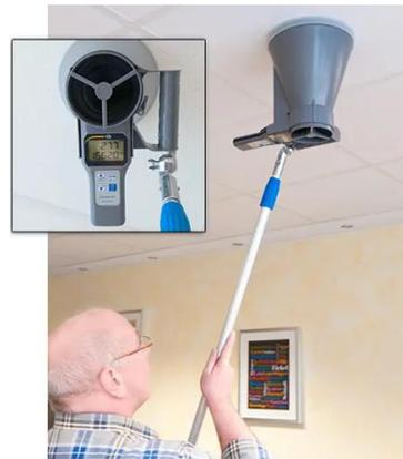
写真3 : 円形風量測定アタッチメントでの天井の通風孔の風量測定の様子
