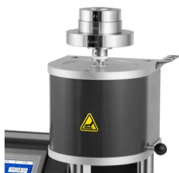
(写真左) ピストンヘッド上の錘を追加した際の様子
