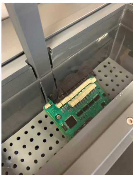
洗浄槽内に試材となる基板をいれた際の様子
