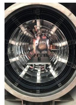
試料搭載時の真空炉内部
