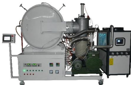
別形状タイプの真空炉一式 + 循環水冷却システム
