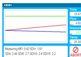
5. 流量が0-15mL/sの範囲で青い線でグラフ化されます。最後の10秒間に流量が0.25mL/s以下の時は実験は最後に有効な数値を表示したまま中止されます。
