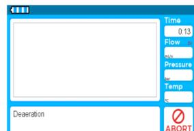
3. "START"ボタンを押すとSDI/MFI試験が開始されて左図の画面を表示、経過時間、流量、圧力、温度が右側の小窓に表示されます。
