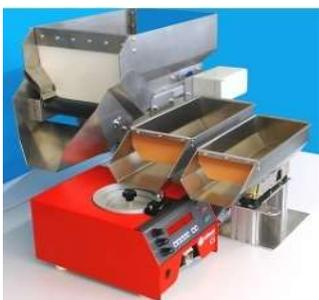
ホッパーとフィーダーのセットで、自動的にコンベアボウルに充填します。
