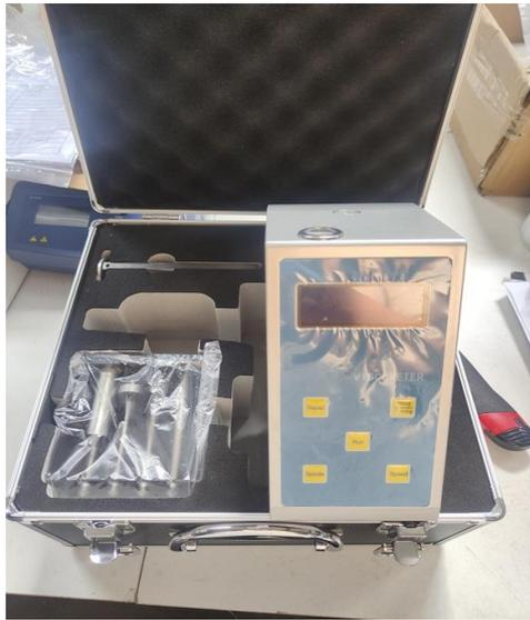
ローター式粘度計は、本体を保護し、輸送中の安全を確保するため、内部が発泡スチロールで覆われたキャリーケースに入っています。
