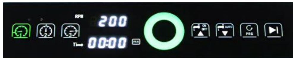
タッチパネル式制御部 グリーンのボタンをタッチしてスピード調整
