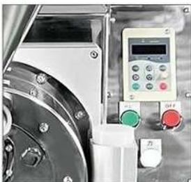
インバータ制御によるディスク速度調整機能
