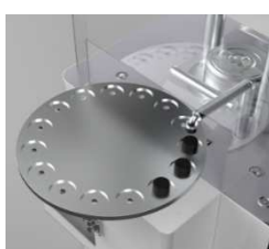
オプションの自動ローディングシステムで処理能力が向上します。
