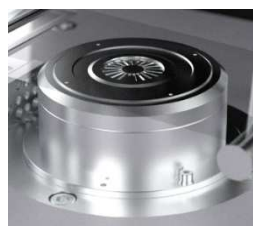
完全に回転する下部ダイと、制限のない振動歪みを提供する固定された上部ダイ。
