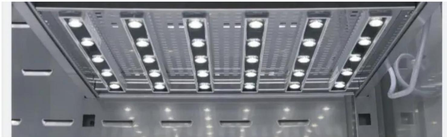
チャンバー内側のLEDライト 調光による 日中/夜間 のシミュレーション システム
